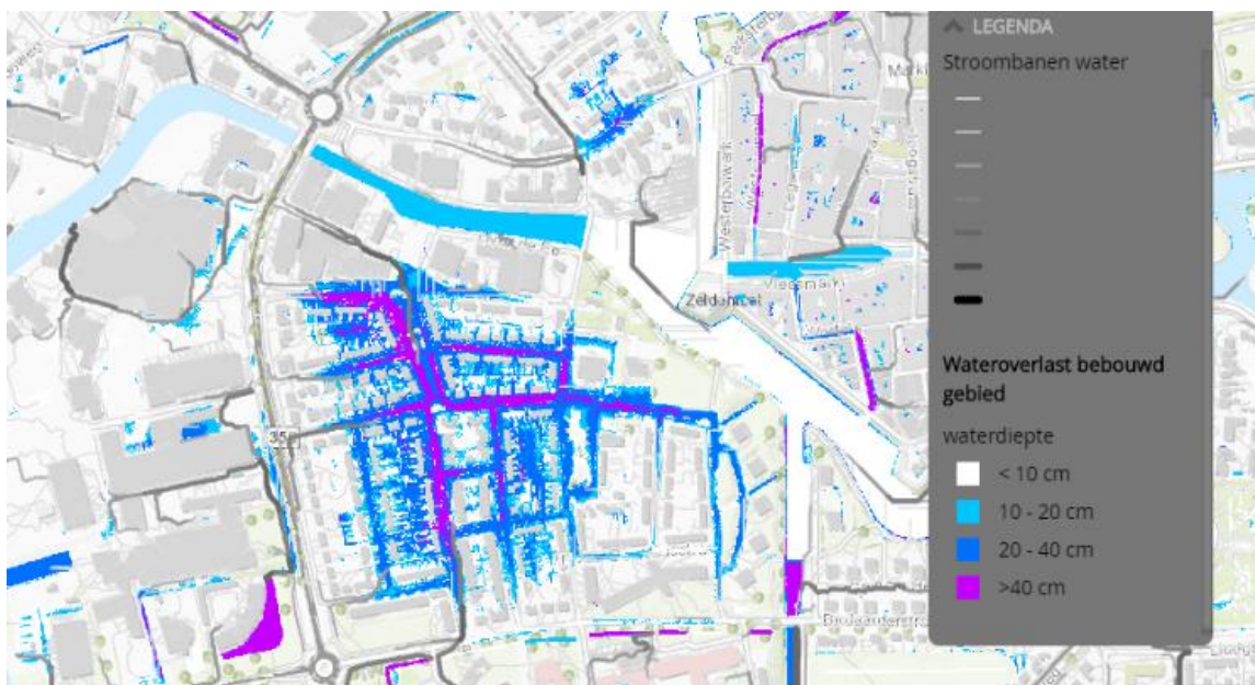
Figuur 1: Wateroverlast in de stad Dokkum bij een regenbui met een intensiteit van 60mm/uur op straatniveau. (Wetterskip Fryslân, 2019)
