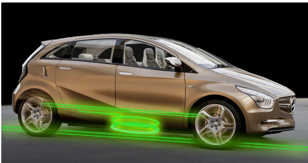
Figuur 9 Inductief laden van een elektrische auto lijkt op het opladen van een elektrische tandenborstel: goed richten is van belang (Studentaward Germany, 2016).
