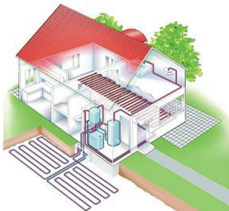
Figuur 2.8 Horizontale bodemcollector
