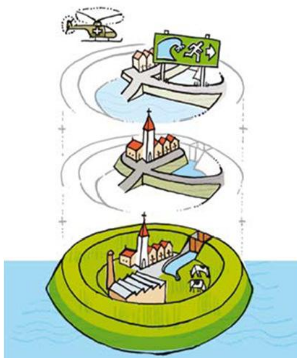
Figuur 2.2 Het concept meerlaagsveiligheid. Van boven naar beneden: rampenbeheersing, duurzame ruimtelijke inrichting, preventie. Bron: Kolen et al (2012).
