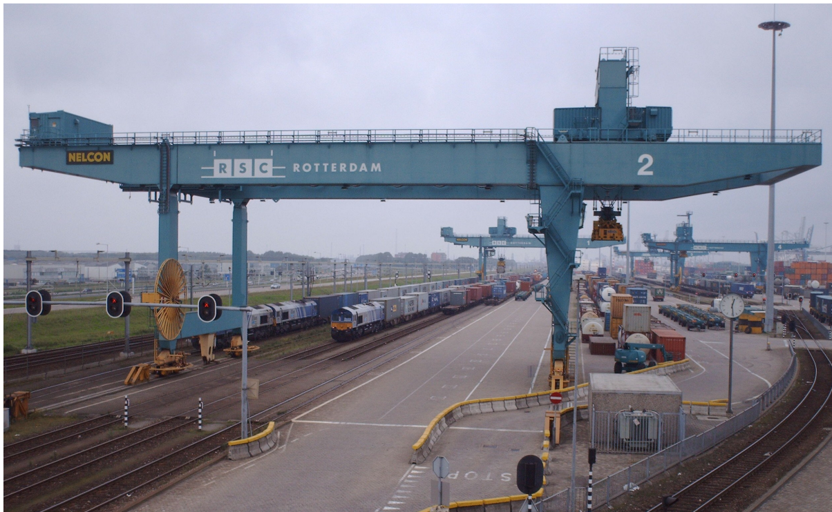
Figuur 6.2.3: Het Rail Service Centre (RSC) in de Rotterdamse Waalhaven. Hier worden onder meer containers overgezet op shuttletreinen.
