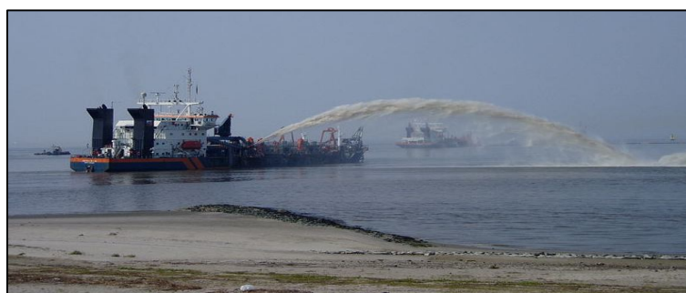
Figuur 10: Rainbowen met een sleephopper (Van Oord, 2008)
