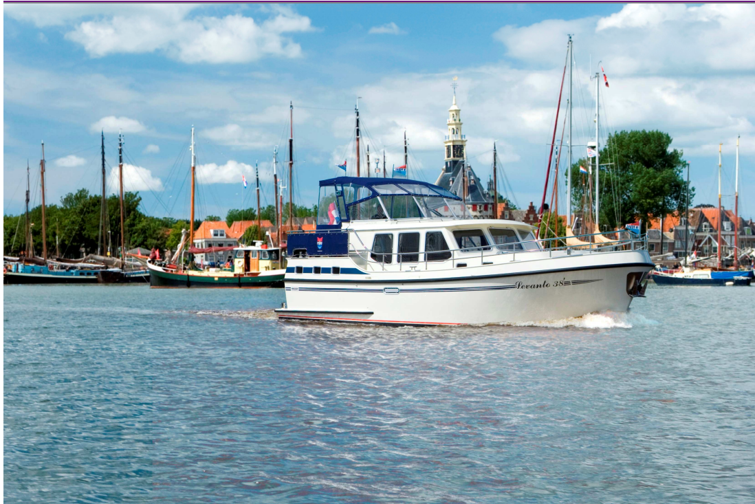
Figuur 3.1 Toervaarschip Cm klasse. Doorvaarhoogte 2,65 meter, diepgang 1,05 meter | Bron: Pedro-boat (2011)
