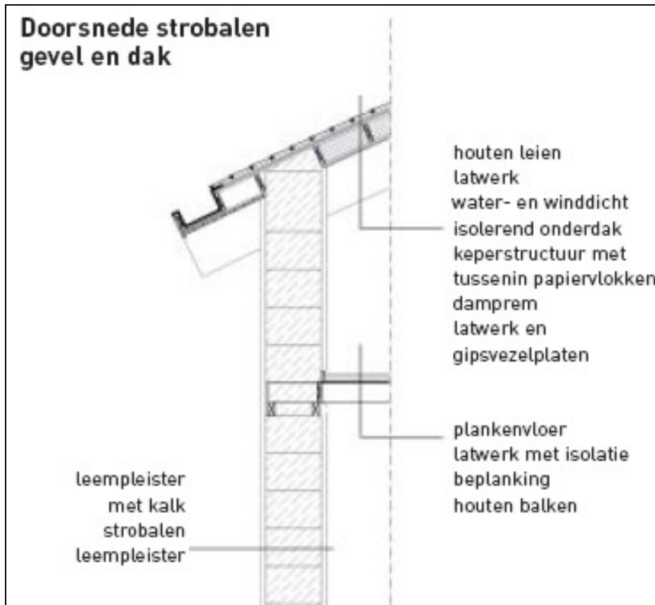
(figuur 9: Muren van stro)
