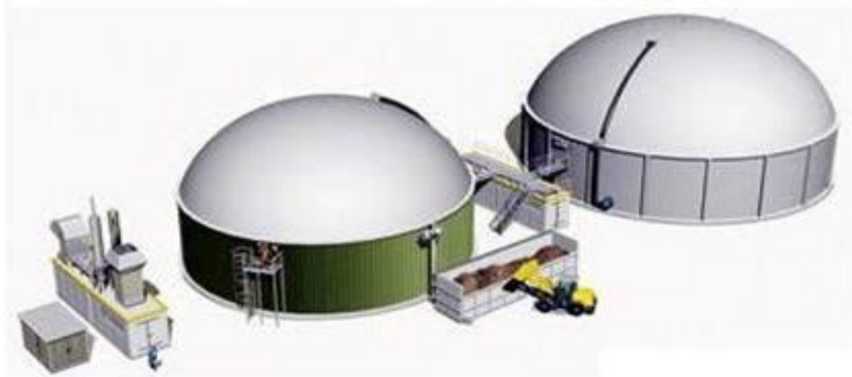
Figuur 3.2: Standaard (co)vergistingsinstallatie (zonder opslagfaciliteiten) Bron: Senternovem (2009)
