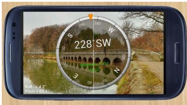
Figuur 1: De Smart Compass app, waarbij er een kompas wordt getoond bij het openen van de camera modus
