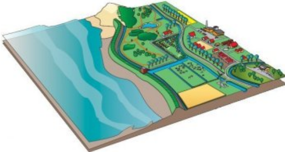
Figuur 2.6 Overslagbestendig maken van dijken
