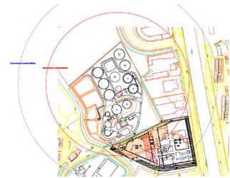
Figuur 12: Geurcontouren rioolwaterzuiveringsinstallatie. Bron: Cauberg-Huygen 2012.
