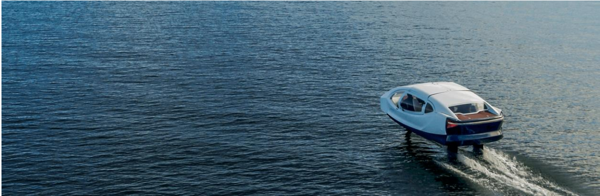
Figuur 23: Bij een ander vervoersconcept kan gedacht worden aan een systeem met kleinere boten, zoals weergegeven in de bovenstaande figuur. De weergegeven boot lift zichzelf bij een bepaalde snelheid op uit het water, wordt volledig duurzaam aangedreven en vaart autonoom. Een prototype heeft al gevaren in de Drechtstedenregio (foto afkomstig van: Sea Bubble).
