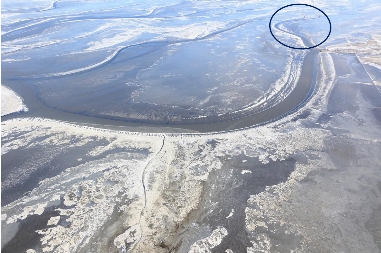
Figuur 4: De vaargeul tussen Holwerd en Ameland, gezien in de richting van Holwerd. De foto illustreert dat het gebaggerde traject beduidend breder is dan de natuurlijke geul. Deze is verworpen tot een klein geultje (foto afkomstig van: Rijkswaterstaat).
